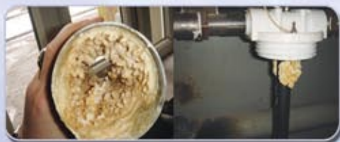
Отложения накипи в реакторе мини-БАУ производительностью до 5 м³/ч в бойлерной ЧАО «Макеевка Газ», Донецкая область.
